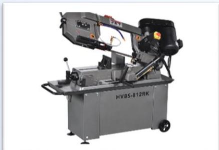
Ленточнопильный станок рассчитан для пиления заготовок большого диаметра. Станок используется для промышленной обработки максимальным диаметром 229 мм, позволяет осуществлять пиление под углами 90° и 45°. Необходимый угол пиления достигается путем поворота губок тисков, регулируемого с помощью шкалы.
