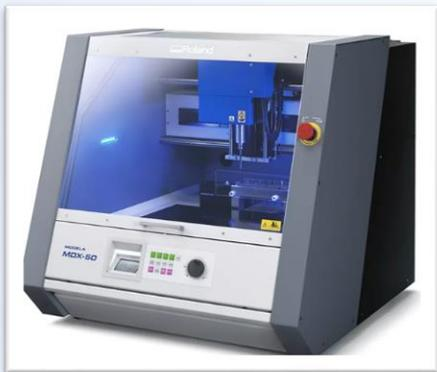
MDX-50 — идеальное решение для моделирования, создания прототипов, а также CAD/CAM-образования. Также вы можете использовать MDX-50 совместно с технологией 3D-печати, изготавливая особенно точные (до 0,01 мм) элементы будущих 3D-объектов. И, что самое важное, в отличие от 3D-принтера мы сможем обработать любой материал, от дерева и воска, до пластика и металла.
