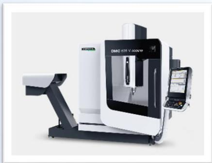
Вертикально-фрезерный центр DMC 635 v предназначен для 3-х осевой обработки небольших деталей сложного профиля из стали, чугуна, труднообрабатываемых цветных металлов, главным образом торцовыми и концевыми фрезами, сверлами в среднесерийном и мелкосерийном производстве.
