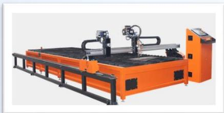
Машина портального типа с ЧПУ легкой серии, которая предназначена для фигурного раскроя листового металлопроката с приемлемой производительностью и степенью загрузки.
