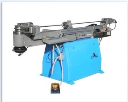
Трубогиб предназначен для холодной, высокоточной, 3-х координатной, дорновой и бездорновой гибки: круглых труб и прутков, при выполнении пространственных гибов, круглых полых и цельных профильных труб, а так же полого квадратного, прямоугольного и овального профильного проката, цельного квадратного и прямоугольного проката, U-образного, уголка, Тобразного и других сложных профилей из стали, нержавеющей стали, титана, алюминия и алюминиевых сплавов, меди и медных сплавов способом наматывания.
