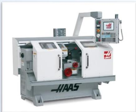
Токарный станок серии Toolroom с ЧПУ; макс. размеры обрабатываемых деталей 406 x 762 мм, кожуха для защиты от стружки, макс.диаметр устанавливаемого изделия 508 мм, векторный привод 7,5 кВт, 1800 об/мин, шпиндель A2-5, визуальная система программирования, система подачи СОЖ, 1 Gб программной памяти, переключатель для блокировки памяти, пневмопистолет, цветной 15-дюймовый ЖК-дисплей и порт USB.
