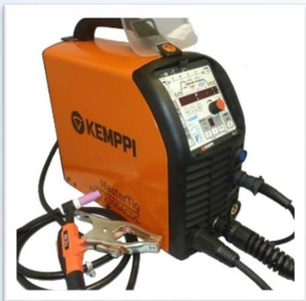
Многофункциональный источник питания с максимальным током 230 А, предназначенным для профессиональной сварки штучными электродами, способами TIG и TIG в импульсном режиме, на постоянном и переменном токе. Кроме того, устройство позволяет сочетать переменный и постоянный ток и работать в режиме MIX TIG (комбинированная сварка TIG). Мощность источника тока регулируется транзисторами IGBTX работающими на частоте около 65 кГц.
