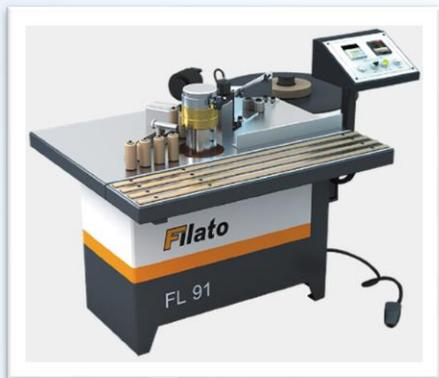
Станок предназначен для облицовывания прямолинейных и криволинейных кромок мебельных щитов и заготовок натуральным полосовым и синтетическим рулонным материалом. Приклеивание осуществляется при ручной подаче заготовки. Подача кромочного материала в зону приклеивания осуществляется автоматически из магазина.
