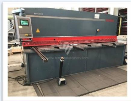
Гидравлические гильотинные ножницы с ЧПУ предназначены для быстрого, точного раскроя листового металла. Оснащены устройством теневого указания линии реза, автоматической регулировкой зазора между ножами и углом наклона верхнего ножа, а также автоматической корректировкой положения заднего упора при изменении зазора ножниц.
