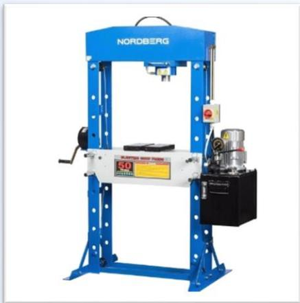
Основное назначение – выпрессовывать и запрессовывать подшипники, глушители и другие элементы из различных деталей и узлов автомобиля. Устройство доступно в двух вариантах сборки: настольная версия и напольная версия. Напольные прессы отличаются большой высотой и большим рабочим пространством. Основной характеристикой является тоннаж, который является максимальным усилием, создаваемым гидроцилиндром.
