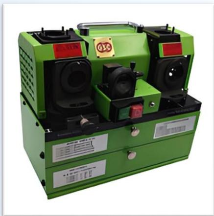
Станок GS-20 предназначен для заточки и доводки спиральных цилиндрических сверл диаметром в диапазоне 2-20 мм, угол заточки в диапазоне 90-140°
