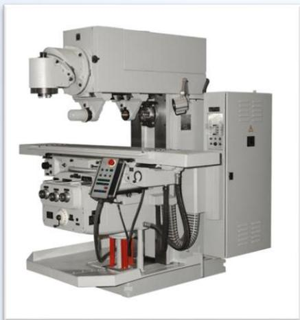
Особенностью данного станка является горизонтальный шпиндель для работы с цилиндрическими и торцовыми фрезами, реализована совместная и раздельная работа пары шпинделей, размещена деталь для уменьшения зазора в винтовой паре продольного движения стола. А при размещении серег, поставляемых в комплекте к оборудованию, данная модель превращается в горизонтально-фрезерный станок.
